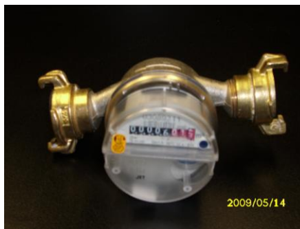
Bild 11 – Wohnungswasserzähler mit Bajonett Schnellverbindern
