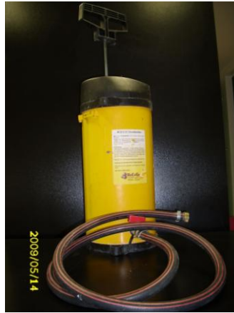
Bild 1 – Druckfüllgefäß, Hochdruckausführung (bis 8 bar)
