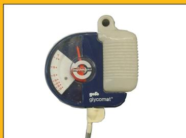
Misuratore caratteristiche fluido termovettore per verificare la sicurezza antigelo del circuito solare (per SOF, FS)
