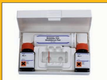
Set completo per la misurazione della diluizione del liquido protettivo K32
