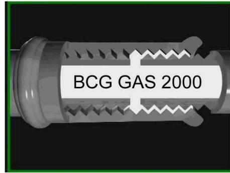
**Bild 38** – Mittel BCG GAS 2000 wird mit dem Druck 4 bar in die undichte Gewindeverbindung der Gasrohrleitung weiter eingedrückt (Phase 2)
