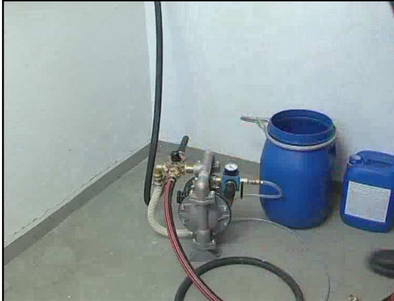
**Bild 36** – Anschluss vom Druckschlauch an die Membranpumpe.
