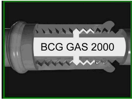
**Bild 37** –Mittel BCG GAS 2000 wird mit dem Druck 4 bar in die undichte Gewindeverbindung der Gasrohrleitung eingedrückt (Phase 1)
