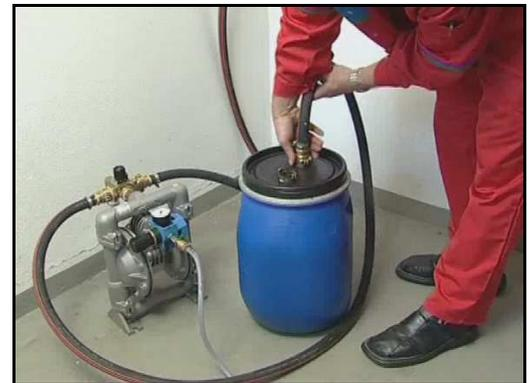
**Bild 35** – Verbindung zwischen dem Speichergefäß und der Membranpumpe mit dem Verbindungsschlauch und den Bajonettschnellverbindern
