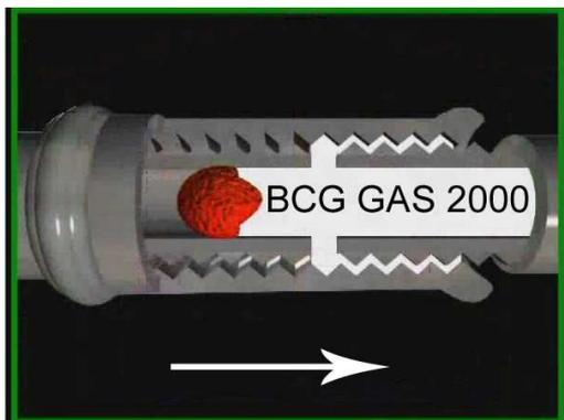
**Bild 42** – Ausdrücken des überschüssigen Mittels BCG GAS 2000 mit dem Molch
