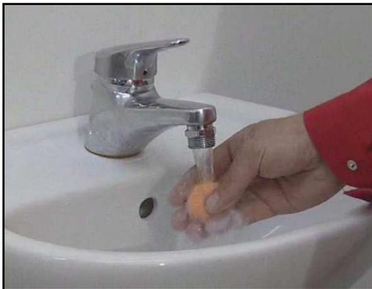
**Bild 17** – Anlagenreinigung – Molch mit Wasserstrahl.
