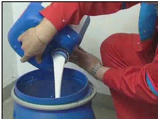
**Bild 34** – Umschüttung des durchgemischten Mittels BCG GAS 2000 in das Speichergefäß
