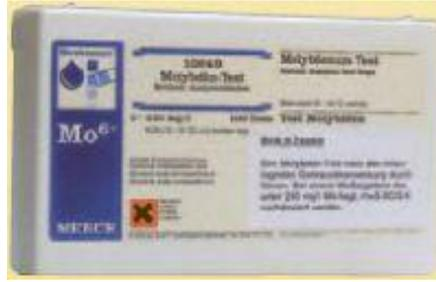
**Bild 13 – Satz zur Bestimmung der Konzentration von Molybdaten im Heizwasser**
