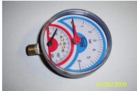
**Bild 2 - Thermomanometer**
