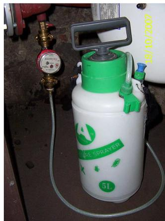
**Obrázek 15 – Anschluss zur Bestimmung der Größe der Medienleckage**
