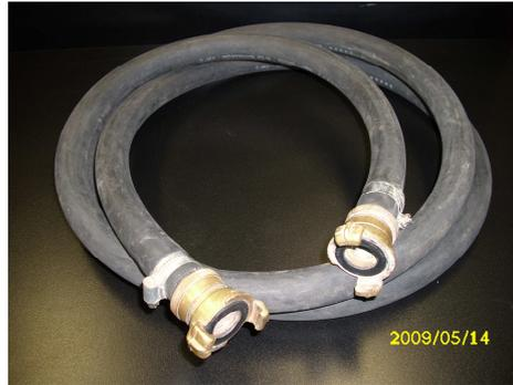
**Bild 10 – Verbindungsschlauch mit Bajonett Schnellverbindern**
