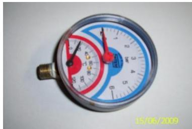
**Bild 3 – Thermomanometer**
