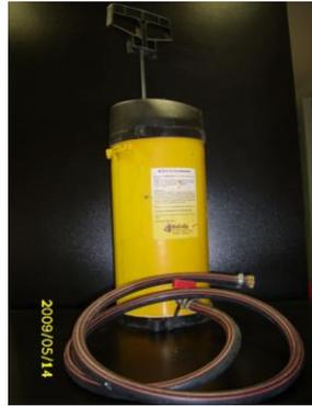
**Bild 2 – Druckfüllgefäß**
